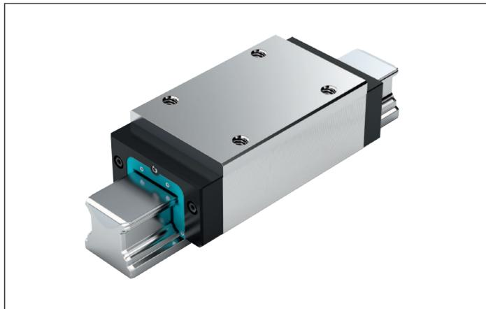
**Dynamikwerte**Geschwindigkeit:  $v_{\max} = 3 \text{ m/s}$ Beschleunigung:  $a_{\max} = 250 \text{ m/s}^2$ (Wenn  $F_{\text{comb}} > 2,8 \cdot F_{\text{pr}}$  :  $a_{\max} = 50 \text{ m/s}^2$ )**Schmierhinweis**
