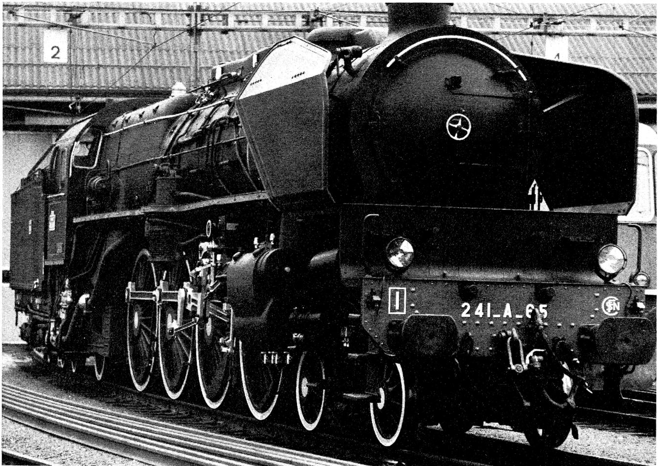
*Bild 1 Die Triebräder mit einem Durchmesser von 1,95 m beanspruchen beinahe die halbe Höhe der Lokomotive*
