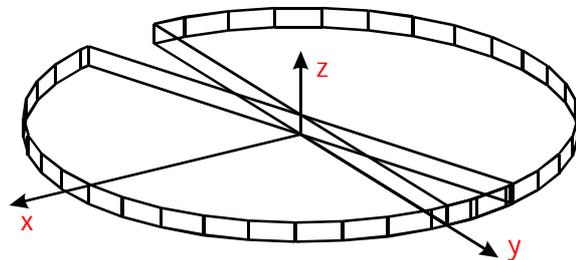
Zur Befestigung der einzelnen Treppenelemente an einer Säule (Radius 15) verwenden wir Drehzylinder (Radius 8), die auf der gegenüberliegenden Seite der Säule 10 Zentimeter hinausragen.
