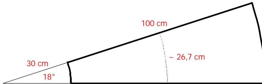
Für ein Stufenelement wählen wir etwa die oben eingetragenen Abmessungen. Mit einer Stufentiefe von rund 26,7 Zentimeter in der Mitte sollte angenehmes Gehen möglich sein.
