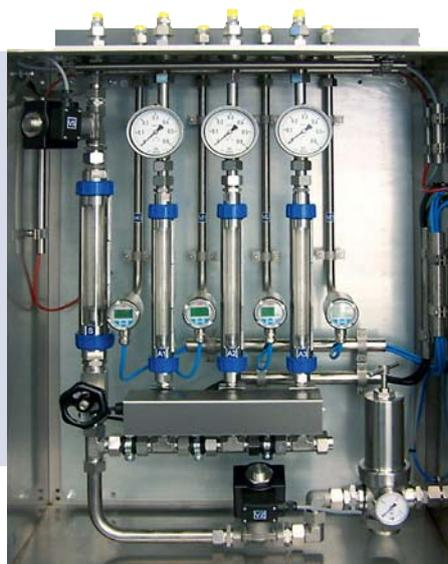
**Le contrôle des centrifugeuses inertées** est basé sur la surveillance de la différence de pression. La pression différentielle maintient une surpression constante fixée dans le système inerté à l'aide des vannes de contrôle.
