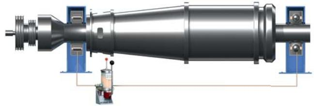
tubes ou flexibles reliés à une pompe centrale. Le lubrifiant est amené proportionnellement par un distributeur spécial à piston. Les roulements de convoyeurs sont étanches et pré-graissés mais ils peuvent également être re-graissés manuellement.
