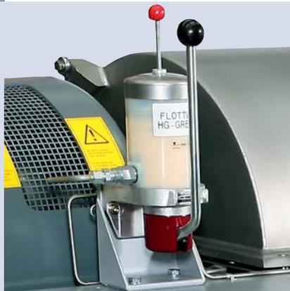
Système de lubrification centralisé (à commande manuelle)
