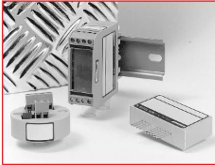
Diese Messumformer wandeln den Widerstand eines resistiven Sensors (z.B. PT-100) in ein temperatur- oder widerstandslineares Ausgangssignal (z.B. 0-10V oder 4-20 mA) um. Bei den programmierbaren Typen werden Messbereich und Nullpunkt mittels DIL-Schalter eingestellt. DIL-Schalter gestatten auch die Einstellung verschiedener Betriebsarten (2/4-, 3-Leiter-Anschluss), Spannungs- oder Stromausgang.
