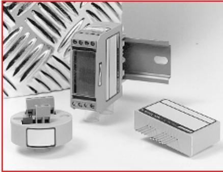
Diese Messumformer wandeln die Ausgangsspannung eines Thermoelmentes in ein thermospannungslineares Ausgangssignal (z.B. 0-10V oder 4-20 mA) um. Bei den programmierbaren Typen werden Messbereich (max. 64mV) und Nullpunkt in 1 mV-Schritten mittels DIL-Schalter eingestellt, alle Einstellungen sind kalibriert. DIL-Schalter gestatten auch die Einstellung verschiedener Betriebsarten (Thermoelmenttyp, Spannungs- oder Stromausgang).
