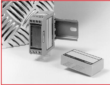
Diese Messumformer wandeln den Eingangsstrom oder die Eingangsspannung in ein normiertes Ausgangssignal (z.B. 0-10V oder 4-20 mA) um. Bei den programmierbaren Typen werden Messbereich und Nullpunkt in 10, 100 oder 1000 mV-Schritten mittels DIL-Schalter eingestellt, alle Einstellungen sind kalibriert. DIL-Schalter gestatten auch die Einstellung verschiedener Betriebsarten (Strom- oder Spannungseingang, Strom- oder Spannungsausgang).
