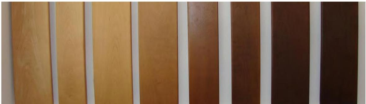
Abb. 9: Thermobuche mit unterschiedlicher Behandlungsintensität (Bild: Timura GmbH)
