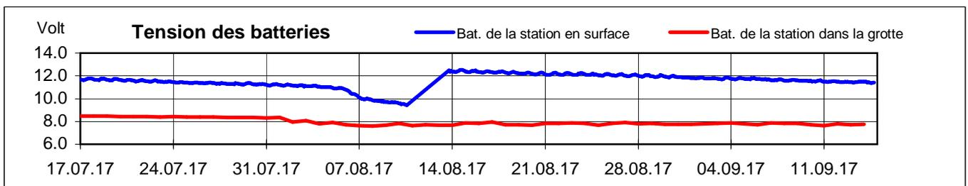
Toutes les 6 heures une mesure de la tension des batteries dans la grotte (courbe rouge) et à l'extérieur (courbe bleue) est effectuée. L'électronique fonctionne sans problème jusqu'à une tension de 6 volts. Comme il s'agit d'accus au plomb, il doivent être changés impérativement lorsque la tension atteint 7.5 volts.
