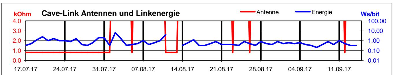
Alle 24h senden die Cave-Link Geräte eine Statusmeldung, in der unter anderem die gemessenen Antennenimpedanz und die benötigte Energie um 1 Bit zur Oberfläche zu übertragen enthalten.
