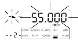
**Exemple:** plage de mesure du capteur: **+/- 50 mm/m**
