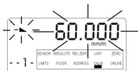
Si le capteur est à la position correcte, la valeur d'étalonnage peut être enregistrée par la touche **ENTER**. Pendant cet enregistrement l'affichage reste stable jusqu'à ce que la valeur soit enregistrée.
