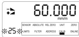
Au moyen des touches **↑↓ ZERO/SELECT "+/-"** le nombre de points de référence peut être modifié. La plage de mesure à étalonner affichée à la fenêtre principale sera adaptée automatiquement. La sélection doit être confirmée par **ENTER**.
