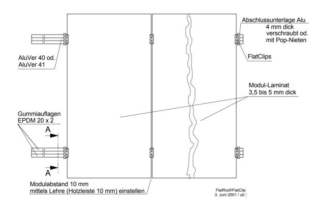
Um zuverlässig eine Verletzung der modulrückseitigen Tedlarschicht zu vermeiden, ist eine EPDM – Gummiauflage für die Profile vorzusehen. Die **AluVer – Clipse** sind im Standardsortiment samt Auflagegummiband verfügbar.
