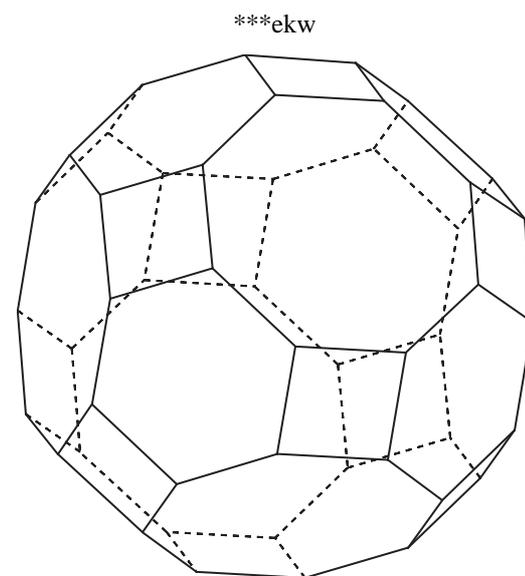
Alle 48 Ecken sind gleich und haben den Raumwinkel 31.25% (Kegelwinkel  $135.95^\circ$ ).
