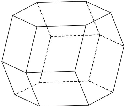
Die Ecke, an die 4 Rauten stossen hat einen Raumwinkel von 20.48 % (Kegelwinkel 107.64°). Wo nur eine Raute an die Ecke stösst, sind es 19.38 % (Kegelwinkel 105.91°). Die Ecken, an die zwei Rauten stossen, haben den runden Raumwinkel  $\pi$ , dh. 25 % (Kegelwinkel 120°).
