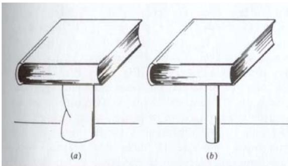
Il est donc préférable de réaliser des éléments de structure ayant un grand diamètre et des parois minces. Il existe toutefois une limite car des structures à parois minces peuvent subir un effet de **flambage** à la suite d'un effort de compression.
