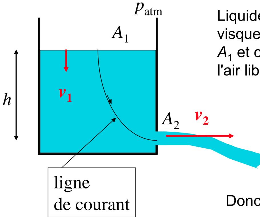
Liquide incompressible et non visqueux. La surface du réservoir  $A_1$  et celle de l'orifice  $A_2 \ll A_1$  sont à l'air libre: pression =  $p_{atm}$
