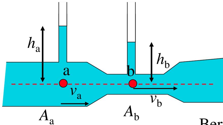
Un rétrécissement du tube augmente localement la vitesse du fluide. Les points a et b sont à la même hauteur:
