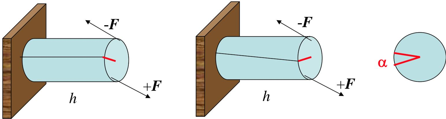
Le cylindre de rayon  $R$  est soumis à un moment de force  $\tau = 2RF$  qui le tord d'un angle  $\alpha$ . Les couches cylindriques sont d'autant plus tordues qu'on s'éloigne de l'axe. L'effet de torsion est à l'origine du cisaillement.
