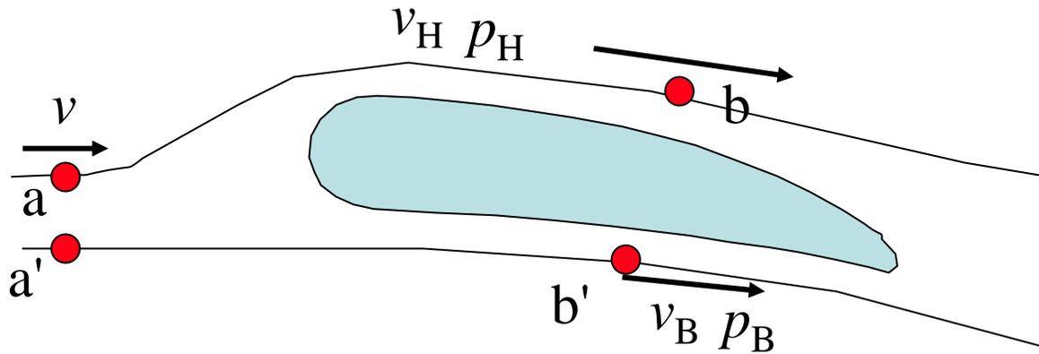
Suivant les deux tubes de fluide, en bas et en haut, on voit que la vitesse doit être plus grande en haut, car le profil y rend le parcours de l'air plus long. Les points a et a' sont équivalents en vitesse et pression:
