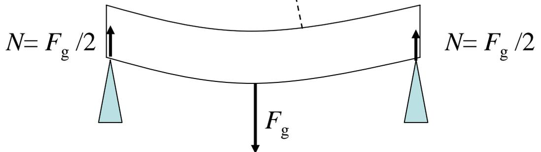
On observe que la partie supérieure de la barre est en compression, celle inférieure en traction
