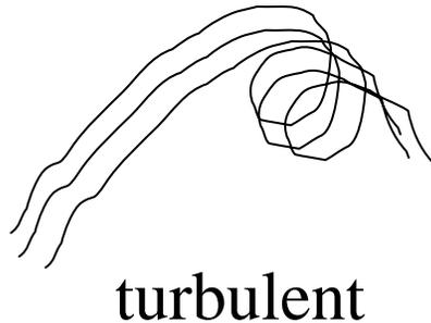
L'écoulement turbulent correspond à un mouvement irrégulier chaotique et variable.
