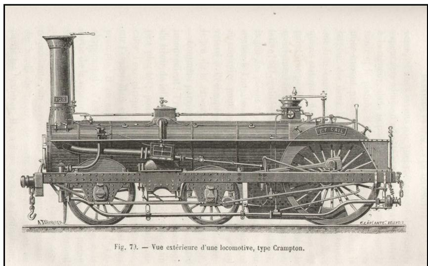
Fig. 71. — Vue extérieure d'une locomotive, type Crampton.
