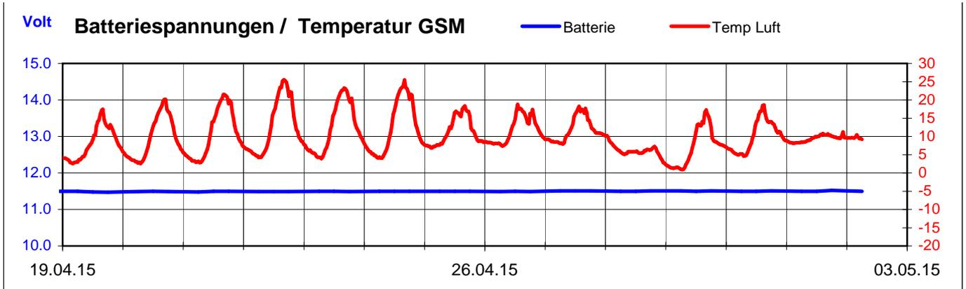
Bei jeder Übermittlung der Daten auf den Server wird die Batteriespannung gemessen. Es sind 6 D-Cellen eingesetzt. Diese sollten bei ca. 6V ersetzt werden. Im GSM-Modul wird alle 30 Min die Temperatur gemessen.
