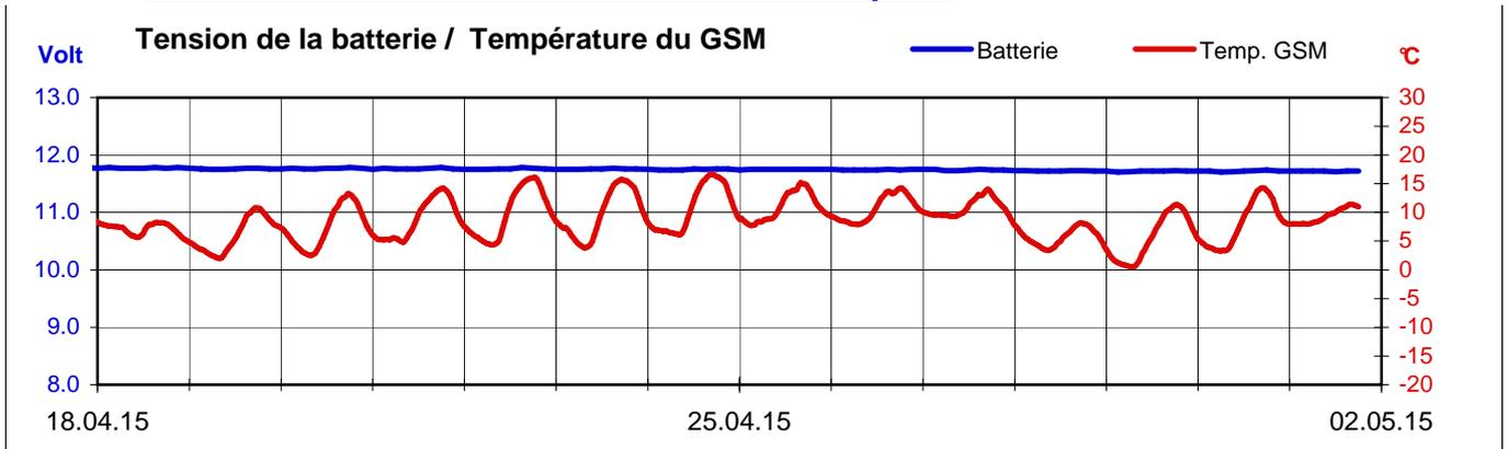
Lors de chaque mesure, la tension des batteries est transmise. Il s'agit de cellules 8-D. Elles devront être remplacées à un niveau de 10 volt environ. Dans le module GSM, la température est mesurée chaque 30 minutes.
