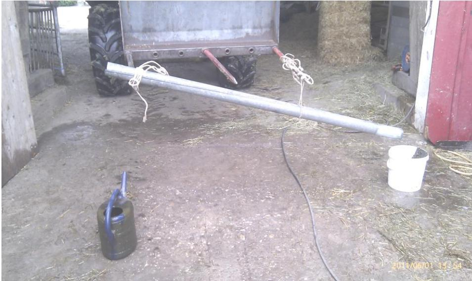
Die Fließfähigkeit soll Aussage darüber geben wie schnell die Gülle vom Blatt abfließt. Gemessen habe ich dies mit einem 2m langen Metallrohr, aufgehängt mit 20% Gefälle. Pro Variante kippte ich 5l oben ins Rohr und stoppte die Zeit bis der erste Tropfen unten ankam sowie auch des kompletten Durchflusses.
