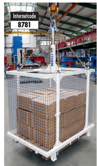
Der vollautomatische Palettengreifkorb PGA1.5 greift die Europalette mittels 4 schwenkbaren Zinken.
