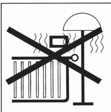
Fühler nicht in der Nähe von Lampen oder über Heizkörpern montieren.
