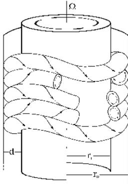
**Abb. 7 : Das Taylor Couette System. Die Strömungslinien verhalten sich wie ein mehrfach gedrilltes Seil, die kleinste stabile Wirbelwalze, die sich läng der Strömungslinien ausbildet, sozusagen das Äquivalent zur Hanffaser beim Seil, nennt sich Taylor'sche Mikrofaser.**
